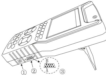
①、电池充电插口：用于电池充电器/通电电源的插口
