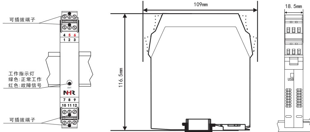
EVT: 工作指示灯：仪表正常工作时，指示灯为绿色；输入信号有故障报警时，指示灯为红色
