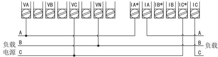
1-2、三相三线系统，采用2PT，2CT方式的接线图（适用于3P3L）
