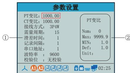
①: 参数说明及设置值, 按“ $\nabla$ ”或“ $\blacktriangle$ ”键移动红框查看对应的参数。按“ $\odot$ ”键出现对话框“请输入密码”输入正确密码按“ $\odot$ ”键确认(出厂默认密码: 1000), 再按下“ $\odot$ ”键在参数对应位置出现光标, 通过“ $\square$ ”、“ $\blacktriangleright$ ”、“ $\blacktriangleleft$ ”、“ $\blacktriangle$ ”键进行修改, 修改完成按“ $\odot$ ”键确认。按“ $\ominus$ ”键退出参数设置画面, 此时会弹出“是否保存参数?”对话框, 选择“是”保存修改过的参数, 选择“否”不保存。
