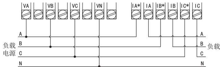
2-2、三相四线系统，采用3PT，3CT方式的接线图（适用于3P4L）
