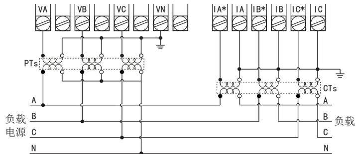
2-3、三相四线系统，采用无PT，3CT方式的接线图（适用于3P4L）
