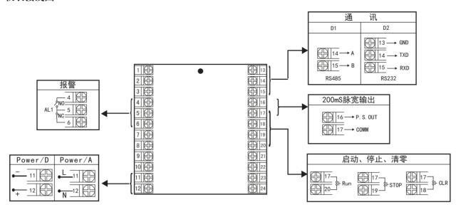
注: 不同外型仪表后盖接线端子的方向不一样, 见示意图
