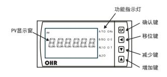
备注:外形尺寸为96\*48mm时, 无Hz、C、T指示灯。
