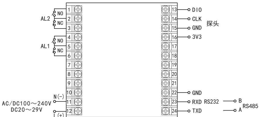
探头外部接线方法：3V3—红色线，GND—黄色线，CLK—蓝色线，DIO—绿色线/黑色线
